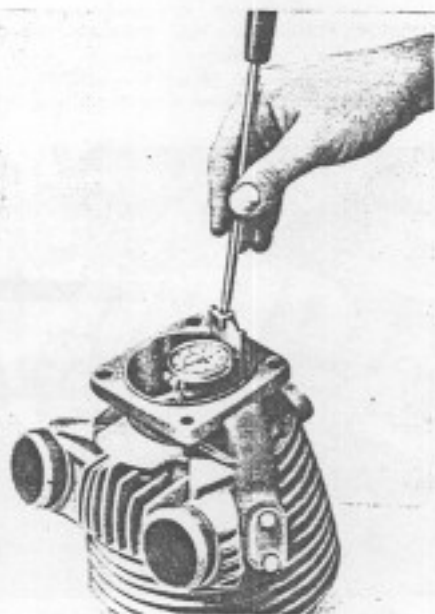
Bild 63. Einführen der Meßuhr in die Zylinderbohrung (Achtung, Schlitten nicht verkanten und Fühl- und Führungsstift nicht in Steuerschlitze schnappen lassen!)
